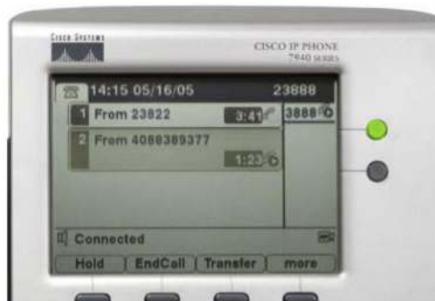
Figure 2. Détail de l'écran haute résolution et des touches de lignes rétroéclairées
